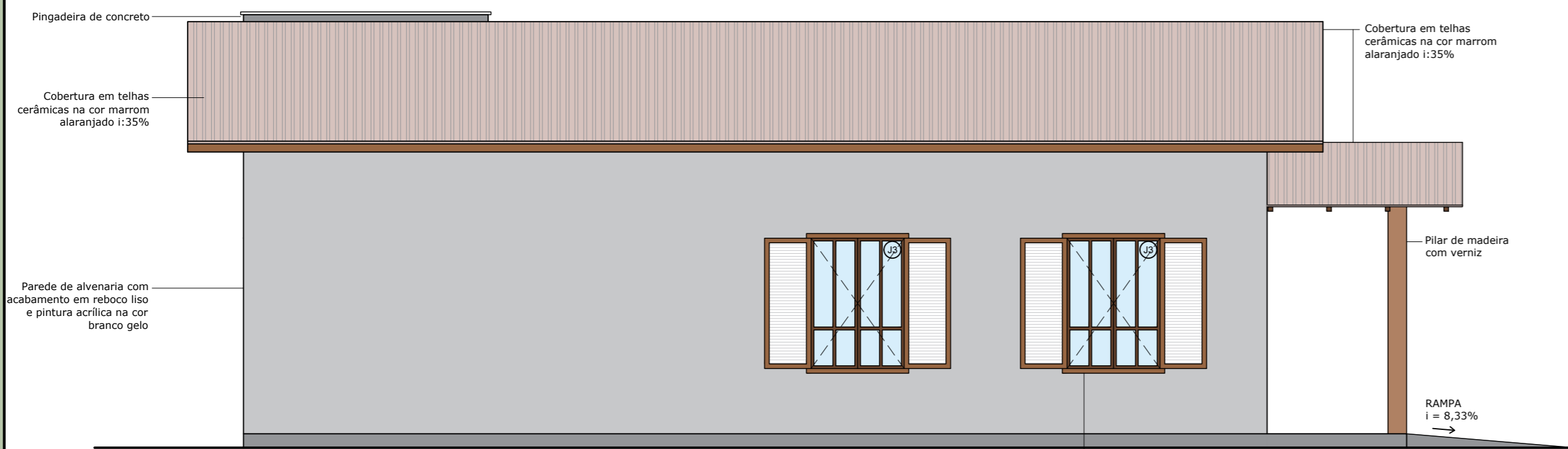
J3 - Janela de abrir - 2 Folhas de abrir em veneziana de madeira e duas folhas de abrir em madeira e vidro
